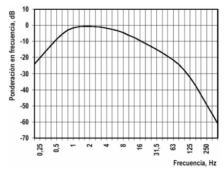
En la tabla A.1 se proporcionan los valores en bandas de tercios de octava de la ponderación en frecuencias Wm, tomando la aceleración como magnitud de entrada y calculados a partir las frecuencias medias verdaderas, para la banda de frecuencias comprendida en el intervalo cerrado de 1 Hz a 80 Hz.
